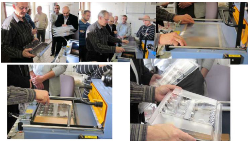
Vákuové tvarovanie v laboratóriu. Z prezentácie prof. Ing. Ivana Chodáka, DrSc.
